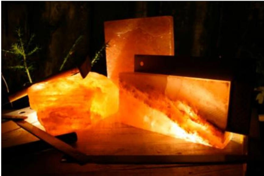
Es ist ein Steinsalz d.h. es wird aus ca. 400-900 m Tiefe im Bergbau gewonnen. Das Salz ist sehr hart, eigene in Auftrag gegebene Belastungsversuche haben gezeigt, dass ein ca. 20x10x5 cm Salzstein erst bei einer Belastung von ca. 45t bricht. Das kommt daher dass das Salz über 250 Mio. Jahren unter einem unvorstellbaren Druck gepresst wurde. Die einzelnen Moleküle haben sich daher so verdichtet das diese nur noch durch Hitze (<800°C) getrennt werden können.
